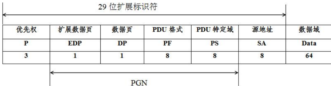
图 8 扩展标识符由优先权、PGN 消息参数群、源地址组成
