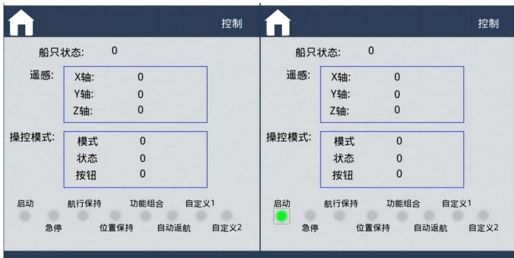
图 19 组态屏显示无人船启动成功
