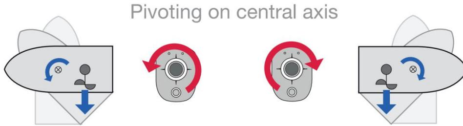
图 11 船舶运动方向与摇杆操作左右扭转方向
