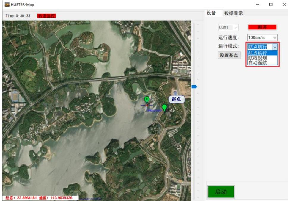
选择航点飞行，在地图区域内随机单击几个锚点，设置好相应允许速度，点击任务设置按钮，则会弹出“设置成功”提示框。
